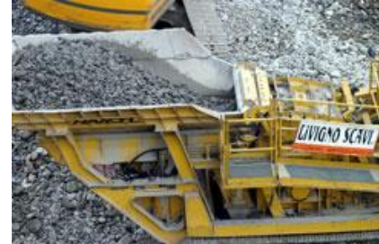
sopra: frantumazione effettuata con impianto mobile con mulino a martelli
