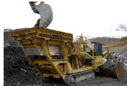
sopra: frantumazione effettuata con impianto mobile con mulino a martelli
